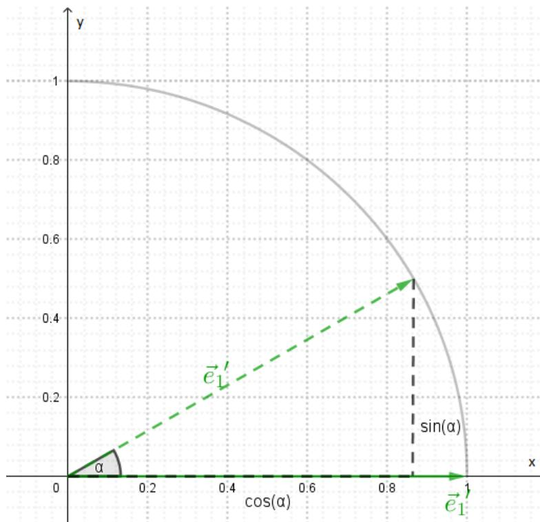
**Abbildung 2:** Die Koordinaten des um  $\alpha$  gedrehten Basisvektors  $\vec{e}_1$  können aus der Kenntnis des Einheitskreises gewonnen werden.
